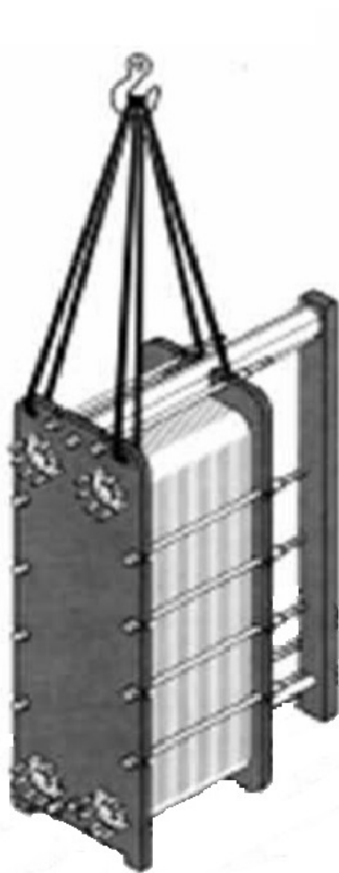
Строповка теплообменника с транспортировочными отверстиями
