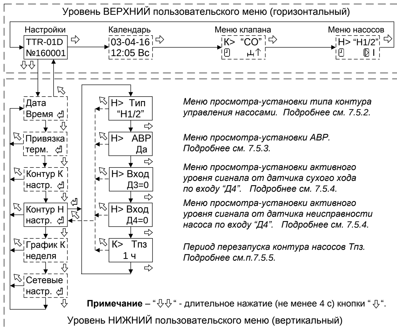
Рисунок 9 - Структура меню настройки параметров контура управления насосами.
