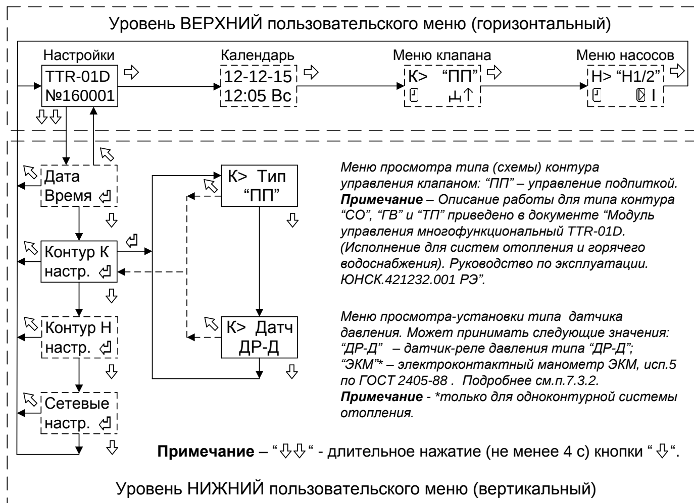
Рисунок 4 - Структура меню настройки параметров контура клапана подпитки
