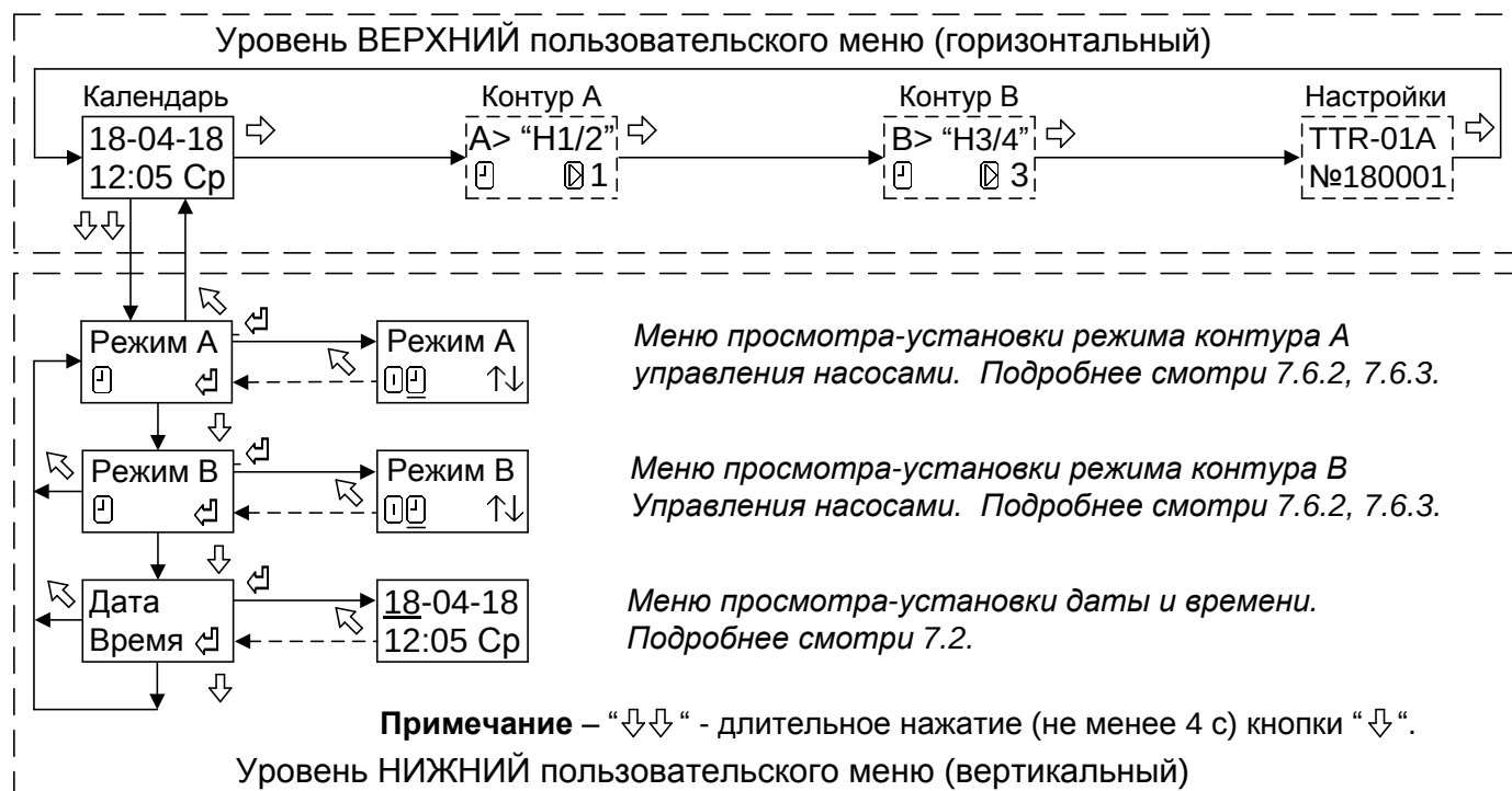
Рисунок 9 - Структура меню настройки режима работы контура
